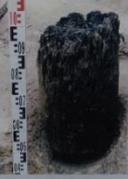
Base d'un des deux jambages du chevet supportant la canalisation d'amenée d'eau de la roue hydraulique.
